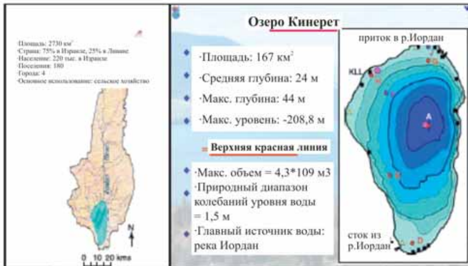
Рис. 6. Водосборная площадь Галилейского озера и отличительные данные по озеру
